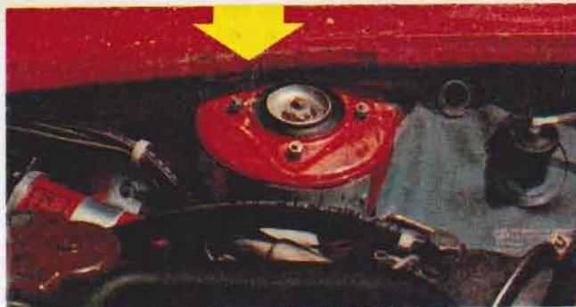
Dove indica la freccia (sopra) la saldatura si sta già aprendo. Con l'andar del tempo gli attacchi degli ammortizzatori tendono o a « chiudersi all'interno » o ad « aprirsi ». Sotto, si è rivelato fragile anche l'attacco del tirante-motore
